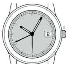
Die Krone ist losgeschraubt. Drehen Sie Krone, um die Uhr aufzuziehen. Ziehen Sie die Uhr bei der Inbetriebnahme oder nach einem Stillstand durch mindestens 25 Kronenumdrehungen auf.
