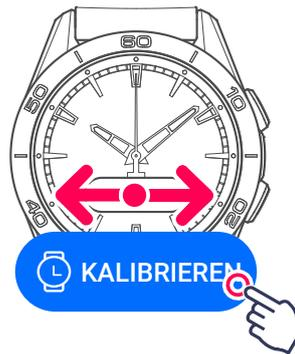
Die Uhr führt eine Zeigerkalibrierung durch, um sicherzustellen, dass die Position der Zeiger korrekt ist.
